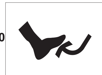
10 Acione por 3 vezes o pedal de embreagem para que o Servo busque o seu melhor alinhamento com o furo da alavanca de embreagem
