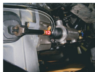
9 Ligue a mangueira de ar proveniente do reservatório ao conector (12) montado sob o eixo do Servo
