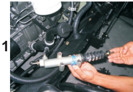
1 Solte o cilindro auxiliar (1) da carcaça do motor, não desconecte o óleo
