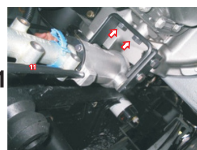
11 Após, aperte os parafusos indicados que fixam o suporte (2) na carcaça do motor.
