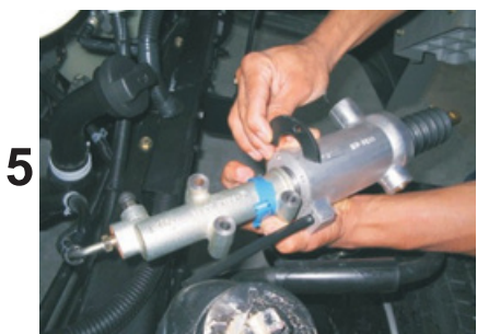
5 Acople o Servo (4) ao cilindro auxiliar (1), utilizando as flanges (3), e os parafusos M6 x 18
