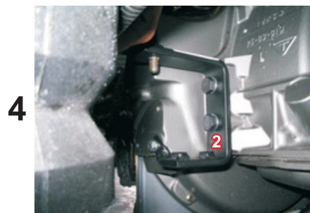
4 Inicialmente sem apertar, fixe o suporte (2) na carcaça do motor utilizando os parafusos M12 x 20 e M 8 x 20
