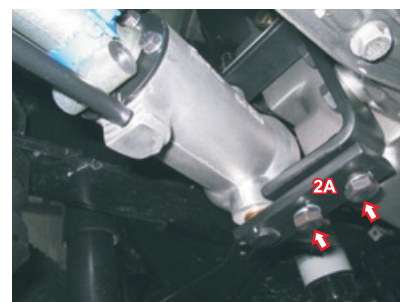
7 Encaixe a parte inferior do suporte (2A), e aperte os parafusos M10 x 30
