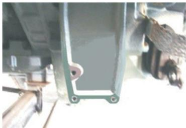
Desconecte o tubo de óleo e retire o cilindro auxiliar do veículo.
