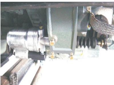
Monte o servo ao suporte original e fixe-o com os parafusos originais. A rótula da haste de acionamento deve estar acoplada ao olhal da alavanca de embreagem
