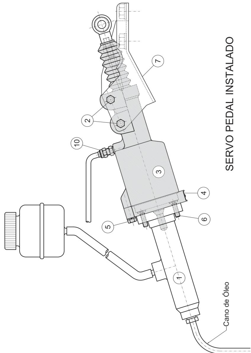
SERVO PEDAL INSTALADO
