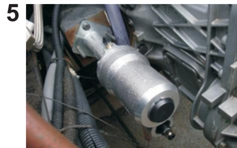
Parafuse o servo SAF 63, atentando para o correto encaixe da haste de acionamento ao garfo de embreagem.
