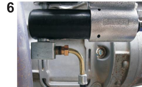
Abra o sangrador do servo SAF 63, tire a tampa do reservatório de fluido de freio e mantenha-o no nível completo. Então desconecte o tubo de óleo do cilindro auxiliar, tampando-o com o dedo polegar e conecte-o ao servo SAF 63.
