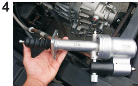
Acople a coifa e a haste retiradas do cilindro inferior original ao servo SAF 63.
