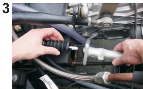
Retire a coifa com a haste de acionamento do cilindro inferior original.
