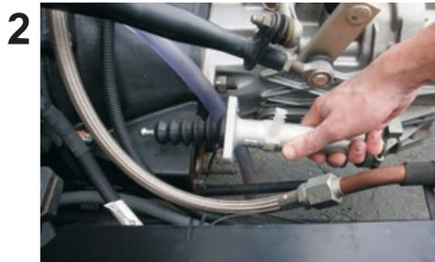
Afrouxe lentamente a porca do tubo de entrada de óleo sem que o fluido escoe, para facilitar sua retirada posteriormente. Solte o cilindro inferior original da capa seca, sem desconectar o tubo de óleo.
