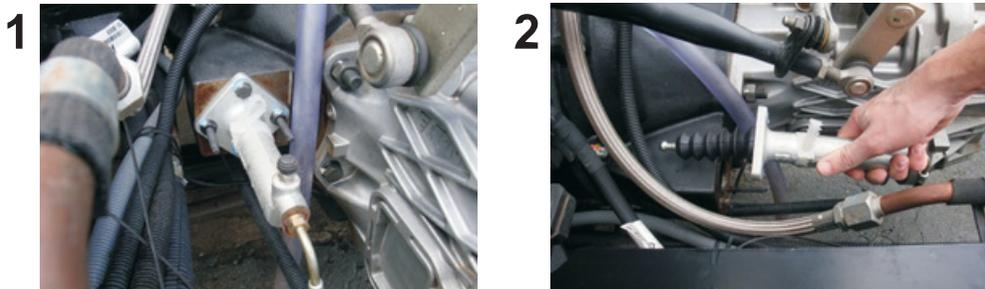
Vista do cilindro inferior original. Este cilindro é retirado e em seu lugar instala-se o SAF 63. Deve-se atentar para substituir os servos sem que entre ar na tubulação de óleo, o que pode provocar dificuldade de sangria devido este modelo de caminhão ter sido montado com a tubulação de óleo entrando por cima do cilindro mestre.
