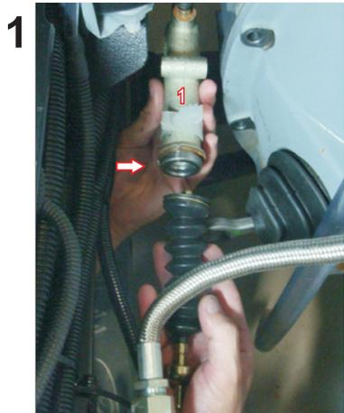
Sem desconectar o tubo de óleo, solte o cilindro auxiliar (1) da carcaça da embreagem e retire a coifa com a haste.
